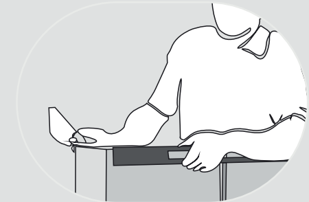
Mortero en ambas juntas verticales
