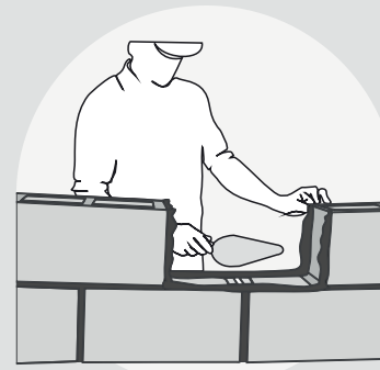
Colocación de morteros en los bloques colindantes
